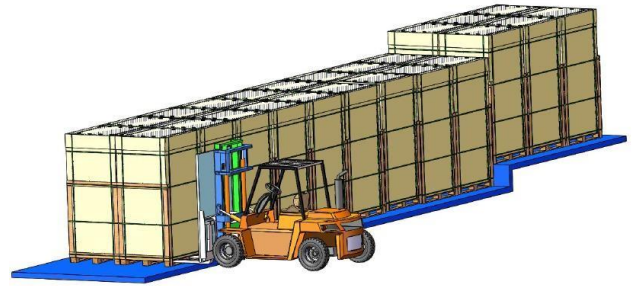
Rozładunek pionowych opakowań o orientacji pionowej za pomocą wózka widłowego
