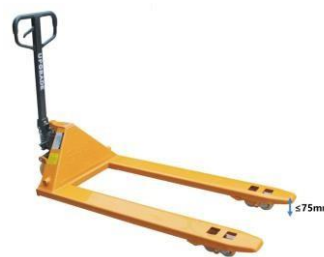
Odległość między górną powierzchnią zębów widel wózka a podłożem
