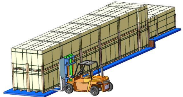
Rozładunek pionowych opakowań o orientacji poziomej za pomocą wózka widłowego
