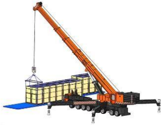
Rozładunek pionowych opakowań o orientacji pionowej za pomocą dźwigu
