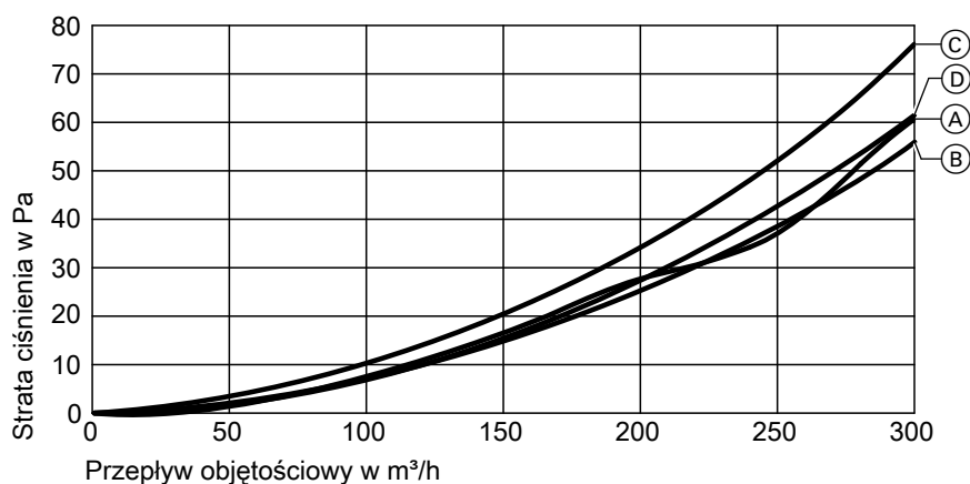
Kompaktowa skrzynka rozdziału powietrza XS z konsolą przyłączeniową 4-krotną R75 XS
