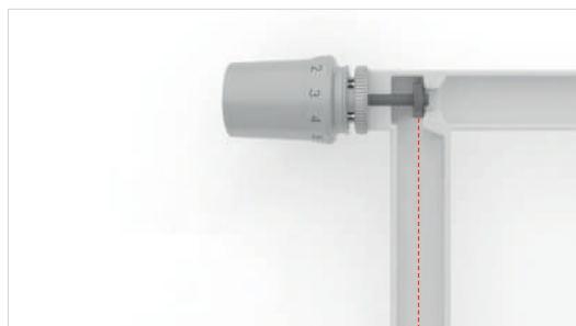
Zawór grzejnikowy zamknięty
