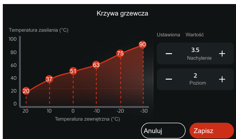
Rys. 24 Przykład: krzywa grzewcza z „nachyleniem” „3,5” i „poziomem” „2”
