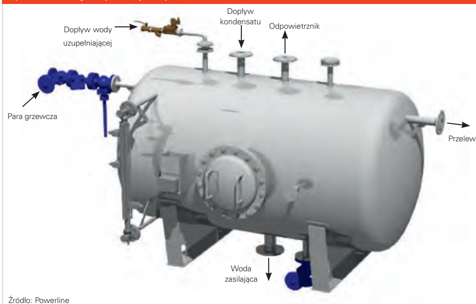
Rys. C.5.3.2-1 Odgazowywacz częściowy
