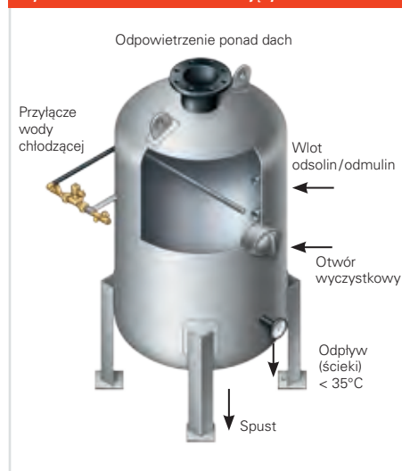
Rys. D.7.1.1-1 Schładzacz mieszający
